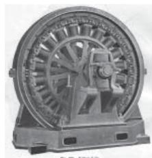
erster Stromgenerator mit Wasserkraftantrieb
